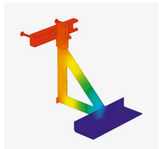
Temperaturverlauf JORDAHL® Verblenderkonsole JVAeco+ P
