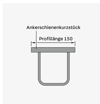
Abhängesystem JFT+ für die Abhängung von Fertigteilstürzen
